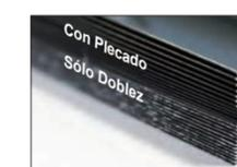
El plecador de impacto evita agrietamiento en aplicaciones de impresión digital. Cuando se opera sólo con plecado, el plecador puede preprocesar 400 gr para materiales gruesos.
