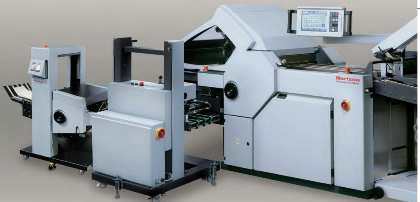
Foro : AFC-566F + Unidad de Alimentación de Pila Redonda RFU-54 + Unidad Móvil de Cuchilla de Doble MKU-38 + Apilador de Prensa PST-44
